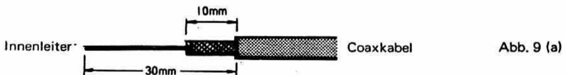
2. Den Coaxsteckverbinder zerlegen. Das zugerichtete Kabelende durch die Bohrung der Überwurfmutter stecken und so weit in den Adapter einführen, bis es vorn aus diesem wieder austritt. Die Maschen des Abschirmgeflechtes mit einer Nadel, Ahle oder einem anderen geeigneten Gegenstand auftrennen und die Abschirmung dann in zwei gleichgroße Stränge teilen.
