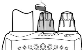
Ruotare il **comando PWR/VOL** in senso antiorario per spegnere il ricetrasmittitore.
