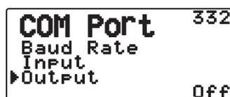
**Waypoint:** Vengono inoltrate le informazioni di waypoint/DGPS. Il simbolo della chiamata e i dati di posizione ricevuti da un'altra stazione possono essere visualizzati come dati di waypoint tramite il dispositivo collegato al ricevitore GPS oppure sul display del ricevitore GPS.
