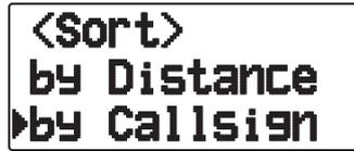
4 Premere [▲]/[▼] o ruotare il comando **Sintonizzazione** per selezionare un tipo di ordinamento, quindi premere [▶OK].
