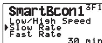
Intervallo di tempo di trasmissione a bassa velocità (1 ~ 100 minuti).
