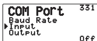
**Off:** Si possono eseguire comunicazioni APRS senza utilizzare un ricevitore GPS o Weather Station. Impostare i dati di posizione stazione manualmente tramite il Menu n. 605 (MY POSITION).
