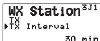
Impostare l'intervallo per la trasmissione dei dati meteorologici assieme alla comunicazione dati APRS.
