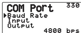
Impostare la velocità di comunicazione del GPS esterno o di un'eventuale altra apparecchiatura collegata al terminale GPS. Quando è connesso un ricevitore GPS la velocità è impostata su 4800 bps (NMEA)/ 9600 bps (formato IPS: SONY).
