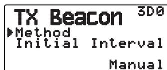
Selezionare il metodo operativo per la trasmissione dei pacchetti APRS. Nella tabella vengono indicate le differenze delle operazioni a seconda della selezione.
