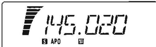
S'il n'y a aucun indicateur, cela signifie que la position de haute puissance a été sélectionnée. Utiliser la haute puissance pour une puissance maximum de l'émetteur.
