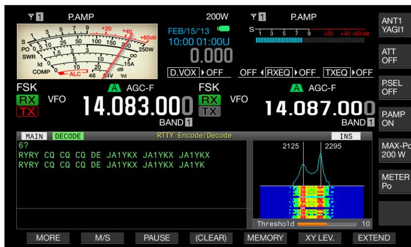
Fig. 107 RTTY Decode/Encode Screen
