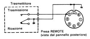
Circuito/relé del trasmettitore per il silenziamento.
