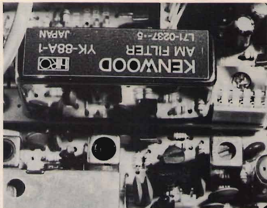
figura 8 Il nuovo filtro inserito al suo posto.
