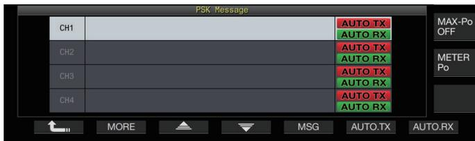
2 Drücken Sie F3 [▲]/F4 [▼] oder drehen Sie den [MULTI/CH]-Regler, um den Kanal zum Speichern der RTTY-Nachricht auszuwählen.
