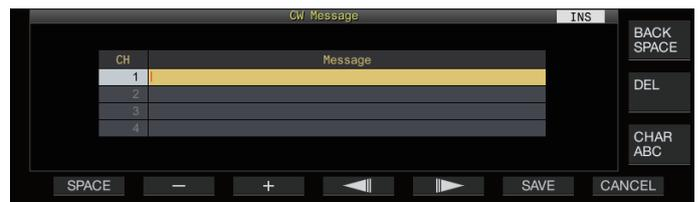
**3 Geben Sie mit den Funktionstasten, dem [MULTI/CH]-Regler oder der USB-Tastatur eine CW-Nachricht ein.**
