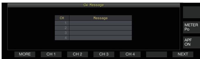
**2 Halten Sie F2 [CH 1] bis F5 [CH 4] oder F2 [CH 5] bis F5 [CH 8] gedrückt, um den Kanal zum Registrieren der CW-Nachricht auszuwählen.**
