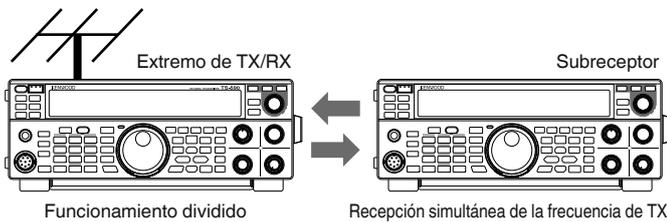
Los modelos de transceptor utilizables son TS-890S, TS-590SG y TS-590S. TS-590S pueden usarse solo como un subreceptor.
