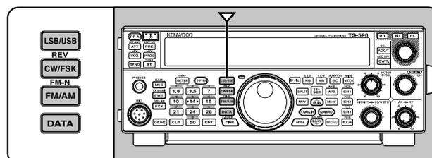
Acceda al Menú N° 27 y pulse **[M.IN]** para seleccionar "on" (activado) para activar el Modo automático. Cuando está activado, aparece "AUTO". De forma predeterminada, si se cambia la frecuencia por encima o por debajo de los 9,5 MHz, el transceptor cambia automáticamente de modo; LSB para las frecuencias inferiores a 9,5 MHz y USB para las frecuencias de 9,5 MHz o superiores. Se puede agregar además los bordes de frecuencia a la selección del Modo automático {página 53}.
