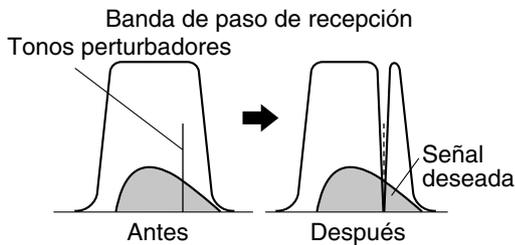
Pulse prolongadamente [BC (A.NOTCH)] para activar y desactivar el Filtro de muesca automática.
