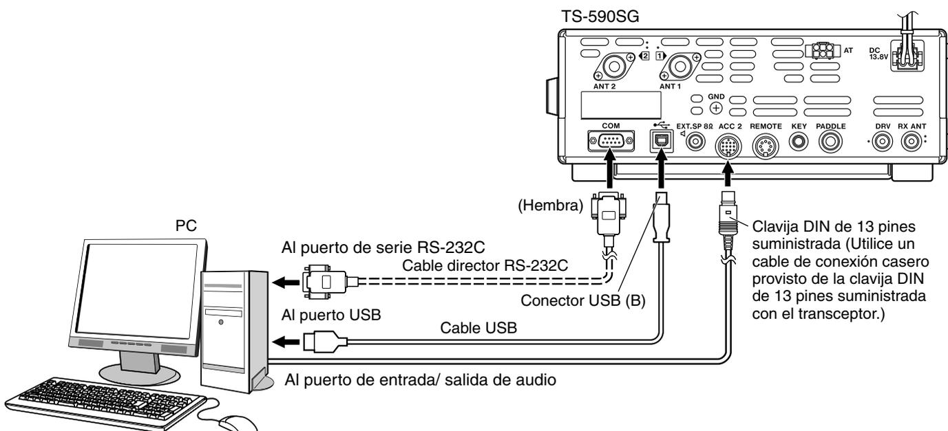
Configure el transceptor según se indica a continuación en función del método de conexión con el PC, la especificación del software utilizado para la comunicación de datos y los ajustes, etc.
