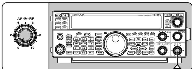
**Nota:** La posición del control **AF** no afecta al volumen de los pitidos que producen las teclas al pulsarse ni al tono secundario de transmisión CW. El nivel de audio de la operación en modo Digital también es independiente de la configuración del control **AF**.
