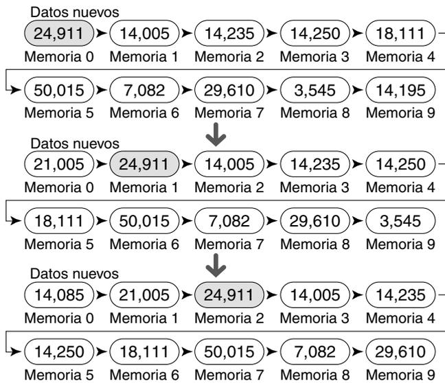
Se pueden almacenar datos en la Memoria rápida solamente cuando se utiliza el transceptor en el modo VFO.
