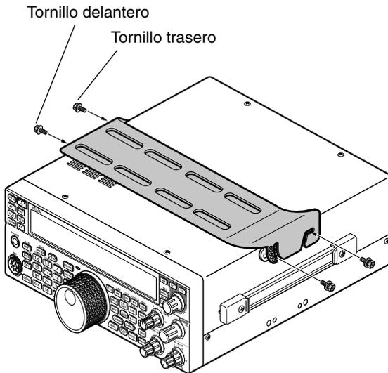
Para quitar el transceptor del soporte, primero extraiga los tornillos delanteros y, a continuación, afloje un poco los tornillos traseros y tire hacia arriba del transceptor para liberarlo del soporte.
