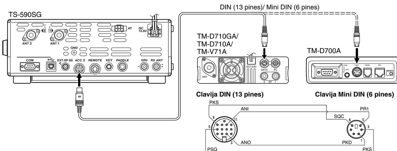
Una vez conectados los 2 transceptores mediante el cable, acceda al Menú N° 80 (Polaridad PSK) y 81 (Bloqueo en ocupado) en el transceptor TS-590SG y seleccione "on" (activado). Asimismo, se deberá ajustar el nivel de entrada/ salida de audio del transceptor TS-590SG utilizando los Menús N° 73 y 74.
