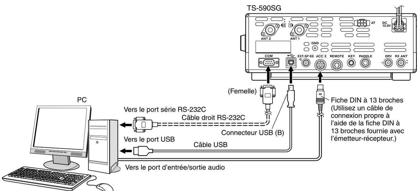
Configurez l'émetteur-récepteur de la façon suivante en fonction de la méthode de connexion avec le PC, la spécification du logiciel utilisé pour la communication des données et les réglages, etc.
