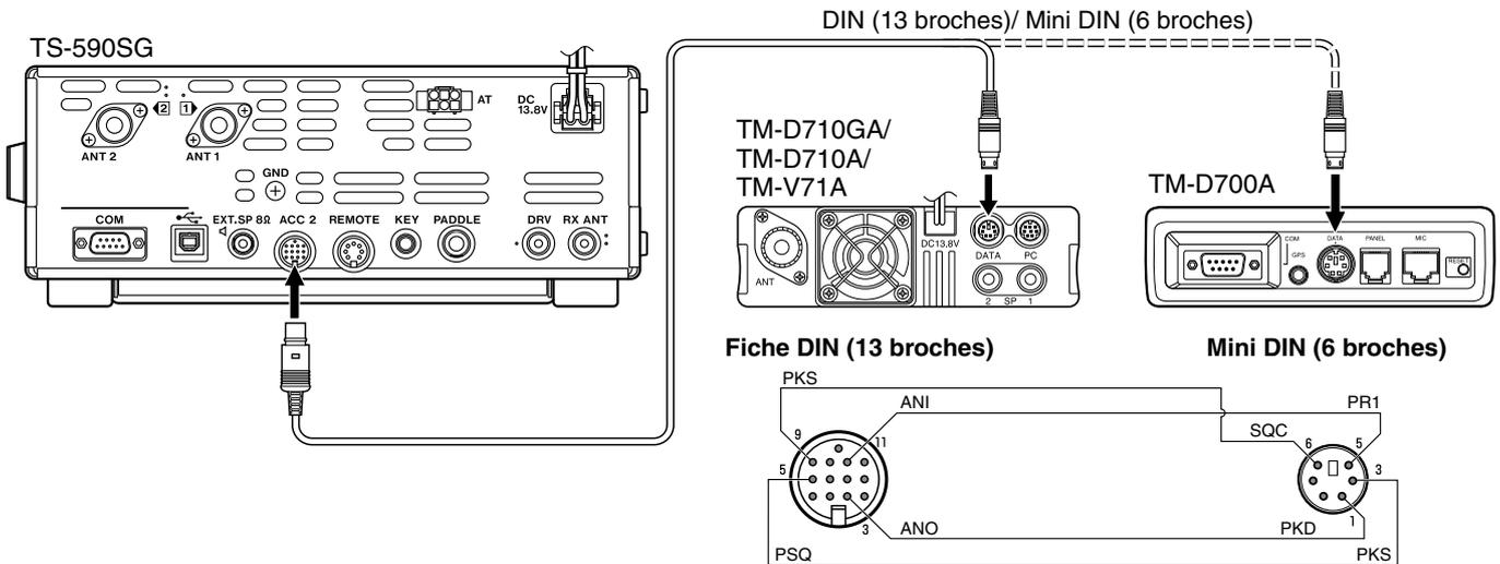
Après avoir connecté les 2 émetteurs-récepteurs au moyen d'un câble, accédez au numéros 80 (polarité PKS) et 81 (Blocage si occupé) du menu sur l'émetteur-récepteur TS-590SG pour sélectionner "on". Vous devrez par la suite régler le niveau d'entrée/sortie audio de l'émetteur-récepteur TS-590SG à l'aide des numéros . 73 et 74 de menu.
