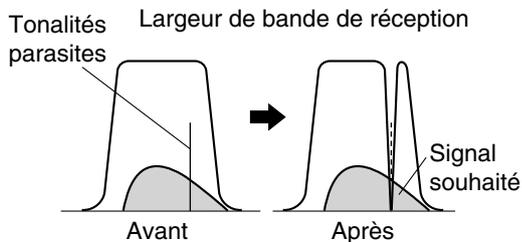
Appuyez et maintenez **[BC (A.NOTCH)]** enfoncée pour basculer entre l'activation et la désactivation du filtre coupe-bande automatique.
