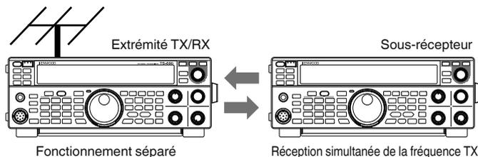
Les modèles d'émetteurs-récepteurs utilisables sont les TS-890S, TS-590SG et TS-590S. Le TS-590S peuvent être utilisés uniquement comme sous-récepteur.
