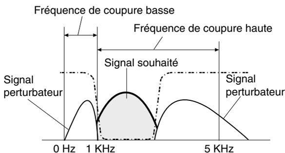
**Remarque :** les fréquences de coupure peuvent être réglées séparément pour chaque mode d'exploitation. Lorsque vous changez de mode d'exploitation, le réglage précédent est rappelé pour le mode choisi.
