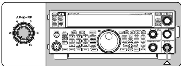
**Hinweis:** Die Stellung des **AF**-Reglers beeinflusst weder die Lautstärke der Signaltöne beim Drücken von Tasten noch den Mithörton beim CW-Senden. Die Lautstärke beim Betrieb des Digitalmodus ist auch unabhängig von der Einstellung des **AF**-Reglers.
