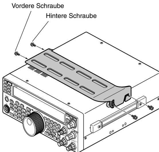
Um den Transceiver von der Halterung zu lösen, entfernen Sie zunächst die vorderen Schrauben. Lockern Sie dann die hinteren Schrauben und ziehen Sie den Transceiver nach vorne, um ihn von der Halterung zu trennen.
