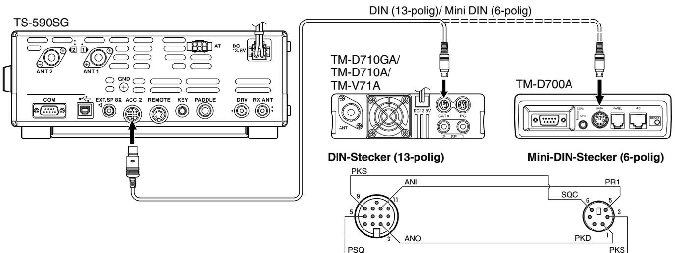
Nach dem Verbinden der 2 Transceiver mit dem Kabel rufen Sie am Transceiver TS-590SG die Menüs Nr. 80 (DTS-Polarität) und 81 (Sperrung bei Signalempfang) auf und wählen Sie "on" (Ein). Weiterhin müssen Sie den Audioeingangs-/ -ausgangspegel des Transceivers TS-590SG unter Verwendung der Menüs Nr. 73 und 74 einstellen.
