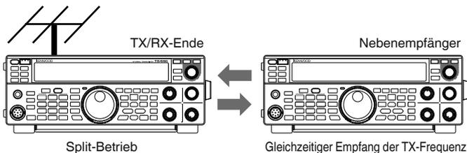
Die verwendbaren Transceivermodelle sind der TS-890S, TS-590SG und TS-590S. Der TS-590S können nur als Nebenempfänger verwendet werden.
