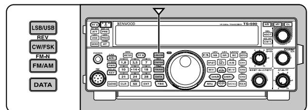
Rufen Sie Menü Nr. 27 auf und drücken Sie dann [M.IN], um "on" (Ein) zu wählen und die Auto-Moduswahl einzuschalten. Wenn diese Funktion eingeschaltet ist, erscheint "AUTO" in der Anzeige. In der Voreinstellung schaltet der Transceiver automatisch die Betriebsarten um, wenn Sie die Frequenz über oder unter 9,5 MHz verändern: LSB für Frequenzen unter 9,5 MHz und USB für Frequenzen größer oder gleich 9,5 MHz. Sie können die Auto-Moduswahl durch weitere Frequenz-Grenzwerte ergänzen {Seite 53}.
