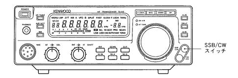
[SSB/CW]を押して電波形式をSSBに合わせます。表示はUSBまたはLSBになります。通常7MHz帯以下ではLSBモード、14MHz帯以上ではUSBモードを使用します。
