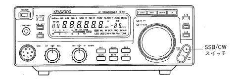
1 「SSB/CW]を押して電波形式をCWに合わせます。 表示はCWになります。
