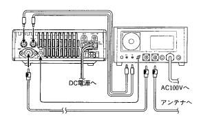
注意 本機のRELAY端子にプラグを差し込むと、 送受信のたびにリレーの切り換え音がしま す。
