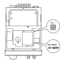
**4** もう片方をTX-RXユニット(→ 図6)の CAL端子(TP3) に差し込みます。
