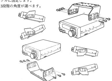
注意 ●トランシーバーを下側から車載アングルに固定する場合は、上 2段のビス穴を使用してください。いちばん下の段のビス穴は 使用しないでください。
