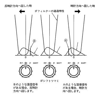
時計方向に回すと、受信周波数の低い方の混信を除きます。この結果、 音質はローカット(高音が強調される)になります。
