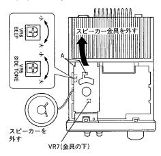
スピーカー金具を外すときは後方に抜いてください。入れるときは最初に前の凹凸を合わせてください。
