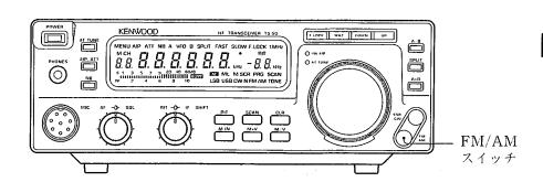
[FM/AM]を押して電波形式をAMに合わせます。 表示はAMになります。 モードの最初の1文字のモールス符号が聞こえます。
