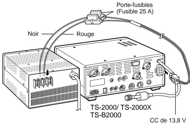
Raccordez d'abord le câble d'alimentation CC au bloc d'alimentation stabilisée; le fil rouge à la borne positive et le fil noir à la borne négative. Raccordez ensuite l'autre extrémité du câble d'alimentation CC au connecteur d'alimentation CC de l'émetteur-récepteur. Resserrez bien les connecteurs jusqu'à ce que la languette de blocage clique en place.
