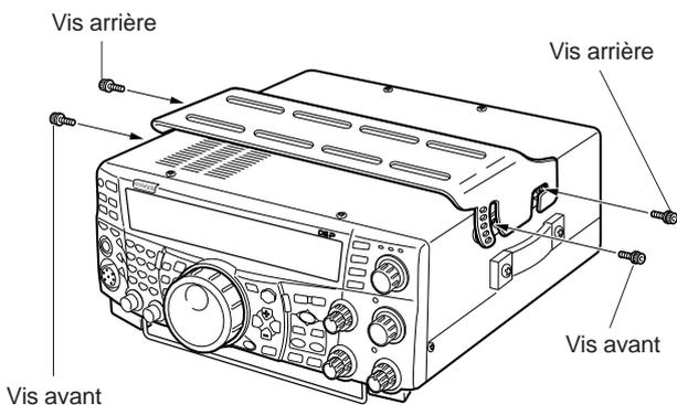
Pour retirer l'émetteur-récepteur du support de montage, retirez d'abord les vis avant, puis desserrez légèrement les vis arrière et tirez l'émetteur-récepteur vers l'avant pour le dégager du support de montage.
