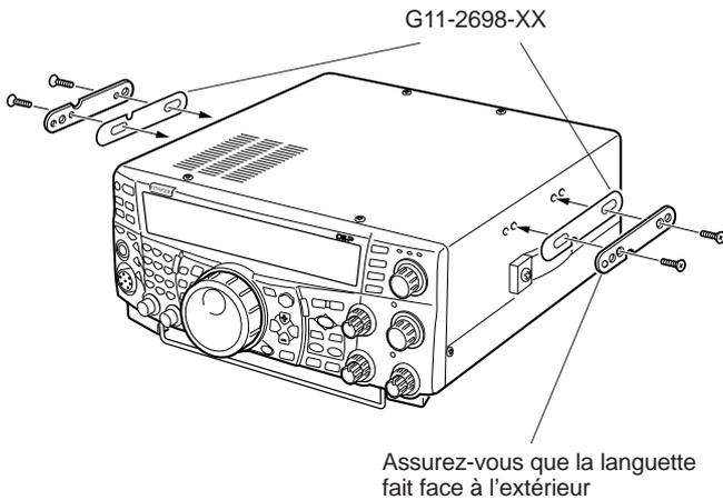
Une fois le support de montage installé dans le véhicule, préparez l'émetteur-récepteur en vissant partiellement les vis arrière. Accrochez ces vis sur le rail-guide arrière du support de montage, puis ajustez l'émetteur-récepteur à l'angle désiré avant de resserrer les vis. Insérez les vis avant et resserrez-les pour assujettir l'émetteur-récepteur.
