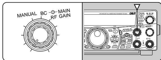
Selon le gain et le type d'antenne utilisée, et selon l'état de la bande, vous pouvez aussi laisser la commande **MAIN RF GAIN** tournée en sens anti-horaire jusqu'au même point, plutôt que de la tourner à fond en sens horaire. Lorsque vous utilisez le mode FM, réglez toujours la commande **MAIN RF GAIN** à fond en sens horaire.
