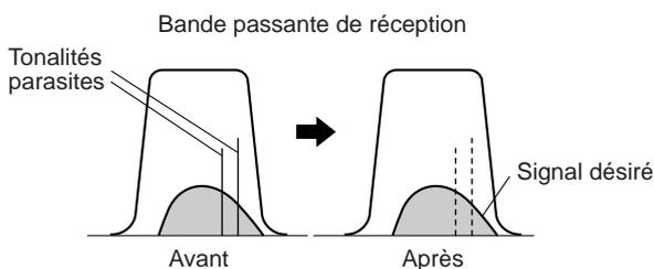
Appuyez sur **[B.C./ MANUAL]** pour mettre la fonction de Suppression de battement automatique en/hors circuit.
