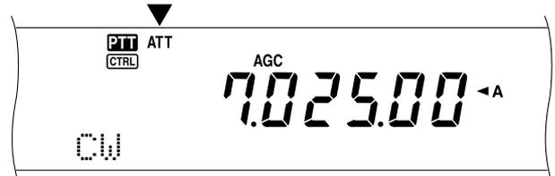
L'état de l'atténuateur (en circuit ou hors circuit) est automatiquement sauvegardé avec la bande courante. Chaque fois que vous sélectionnez une bande de fréquences, le réglage de l'atténuateur est automatiquement rappelé.
