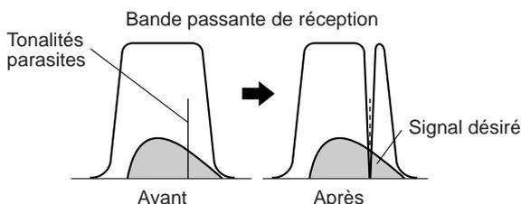
Appuyez sur **[A.N./ LEVEL]** pour mettre le filtre coupe-bande auto en/hors circuit.
