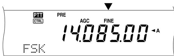
2 Tournez la commande d'Accord pour sélectionner la fréquence exacte.
