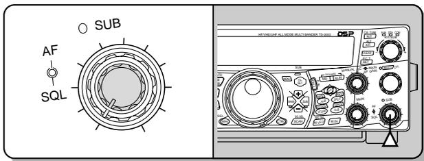
**Remarque:** La réglage de la commande **SUB AF** n'affecte pas le volume de confirmation sonore à l'appui des touches ni le niveau sonore en mode de commutation par paquets.
