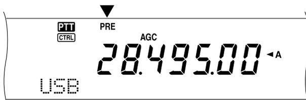
L'état de l'amplificateur (en circuit ou hors circuit) est automatiquement sauvegardé avec la bande courante. Chaque fois que vous sélectionnez une bande, le réglage sauvegardé précédemment est automatiquement rappelé.
