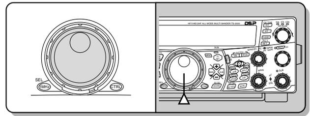
Vous pouvez aussi entrer directement la fréquence au clavier numérique si la fréquence désirée est éloignée de la fréquence courante. Appuyez sur **[ENT]** et utilisez ensuite les touches numériques. Pour plus de détails, reportez-vous à la section "Entrée directe de la fréquence" {page 37}.
