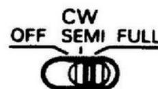
A volte può succedere di usare un codificatore elettronico che non è dotato di un metodo per produrre una condizione continua di trasmissione KEY DOWN. Per ottenere una portante continua per la sintonizzazione, basta regolare l'interruttore di attesa sulla posizione SEND e l'interruttore CW sulla posizione FULL.
