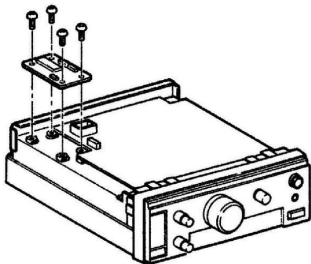
5. Attaccare il connettore DIN dello IF-10C con la staffa e le viti di montaggio in dotazione. Disporre i fili lungo il retro dell'apparecchio.
