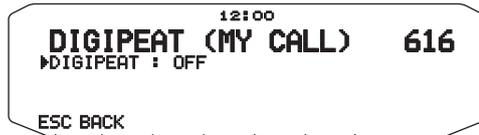
Quando si utilizza il RC-D710 come un ripetitore digitale, configurare se effettuare o meno la ripetizione digitale di un pacchetto che include il proprio segno di chiamata nel percorso pacchetto.
