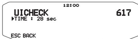
Questa funzione non ritrasmetterà un frame UI ricevuto una volta entro il tempo UICHECK impostato. Questo si verifica per ciascun UIDIGI, UIFLOOD, e UITRACE.
