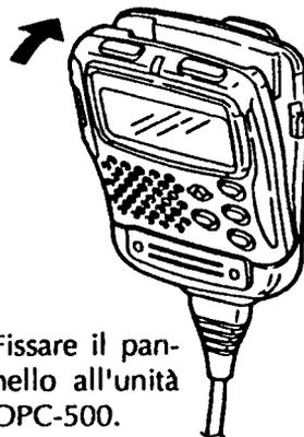
3) Fissare il pannello fittizio al corpo del ricetrasmittitore.
