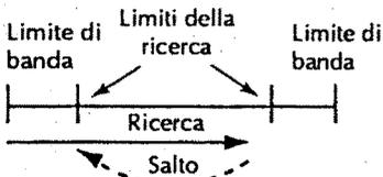
La ricerca si avvia entro dei limiti delimitati in frequenza. Utile per la ricerca entro una banda ristretta quale ad es. le frequenze d'uscita di un gruppo di ripetitori.
