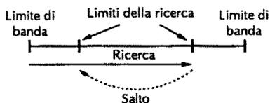
La sequenza avviene ciclicamente fra i due limiti impostati a seconda delle necessità. Una applicazione può consistere nel controllare l'attività di tutti i ripetitori, in tal caso sarà necessario far rientrare nei limiti suddetti le frequenze dei ripetitori ricevibili.
