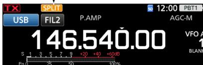
3. Mientras mantiene pulsado **[XFC]**, ajuste el desplazamiento de la frecuencia de funcionamiento entre la transmisión y la recepción.
