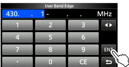
5. Introduzca la frecuencia del borde superior de la banda y, a continuación, toque [ENT]. (Ejemplo: 439,9)
