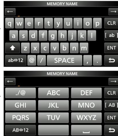
① Puede seleccionar la disposición de teclado completo en "Full Keyboard Layout" de la pantalla FUNCTION.
