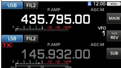
① La frecuencia de la baliza se desplaza (efecto doppler). Gire **(MAIN DIAL)** para ajustar la frecuencia.
