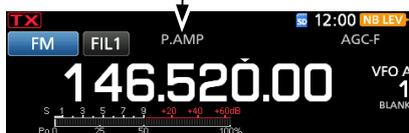
**NOTA:** Cuando utilice el preamplificador durante la recepción de señales potentes, la señal de recepción podría distorsionarse. En tal caso, apague el preamplificador.
