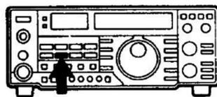
Questo interruttore accende e spegne il preamplificatore del ricevitore quando è installato il preamplificatore IC-AG1 opzionale.
