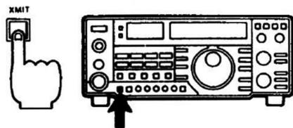
2) Selezionare la modalità di trasmissione con l'interruttore [ XMIT ] o l'interruttore [ BK-IN ] sul pannello posteriore. Fare riferimento all'operazione BREAK-IN a pagina 24.
