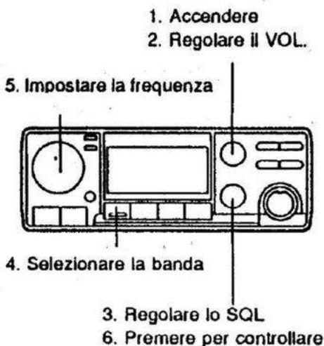
1. Premere il tasto [ON/VOL] in modo da accendere l'apparato, quindi ruotare a fine corsa sinistra il controllo [SQL/MONITOR].
