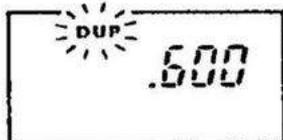
Il visore indica che il valore del passo di duplice è di 600 kHz (0.6 MHz).
