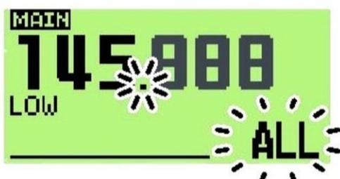
Selezionare mediante il DIAL "ALL" oppure in sequenza da P1 a P9 per la ricerca parziale.
