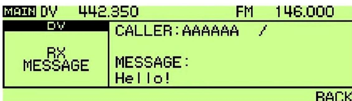
4. Premere due volte [BACK](V/MHz•SCAN) - banda destra - per ripristinare l'indicazione 'Function guide'.
