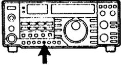
(21) MANOPOLA DEL TONO AUDIO [AF TONE]: questa manopola fa variare la tonalita' del suono del ricevitore. Regolate la manopola per ricevere la tonalita' sonora piu' chiara e piacevole possibile.
