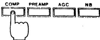
Usando questa funzione, il livello della potenza di modulazione si puo' aumentare per i collegamenti a grande distanza. Si veda il PARAGRAFO 7-1 per ulteriori informazioni.
