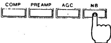
Questa è una funzione molto utile, che riduce i disturbi di tipo impulsivo, come quelli prodotti dai sistemi di accensione delle automobili. Si veda il PARAGRAFO 7-4 per informazioni più dettagliate.
