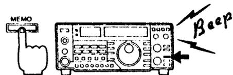
1) Impostate la frequenza su 145.000.0 MHz ed il Modo su FM, usando rispettivamente la MANOPOLA DI SINTONIA ed il TASTO di MODO [FM]. Per selezionare questi parametri si può usare indifferentemente il VFO A o il VFO B.
