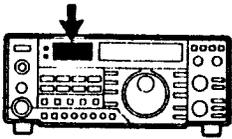
(49) INDICATORE DI TRASMISSIONE [XMIT]: questo indicatore si illumina quando il ricetrasmittitore sta trasmettendo.
