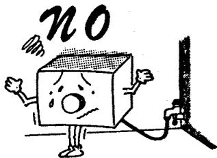
Per evitare folgorazioni, interferenze alla TV o alle radioaudizioni ed altri problemi, assicuratevi di mettere a terra l'apparato, tramite il TERMINALE DI MESSA A TERRA. Per ottenere i migliori risultati, usate conduttori a filo o a nastro della maggior sezione che e' disponibile, e realizzate il collegamento piu' corto che sia possibile.
