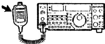
\* La frequenza sul visore risultera' 600 kHz piu' alta di quella di ricezione attualmente indicata in Modo +Duplex, oppure 600 kHz inferiore in Modo - Duplex.
