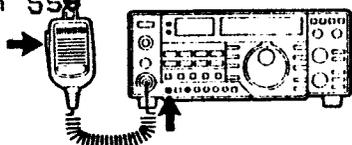
1) Selezionate il modo di trasmissione tramite il TASTO [XMIT] sul pannello frontale o il [PTT] sul microfono.
