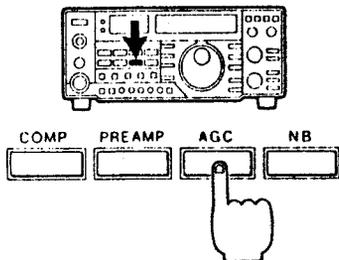
Questo circuito impedisce che si ascolti il fastidioso rumore di fondo durante le brevi pause del discorso. L'effetto di smorzamento dell'AGC permette pertanto anche di effettuare sullo strumento precise letture dell'intensità di picco del segnale di Media Frequenza.
