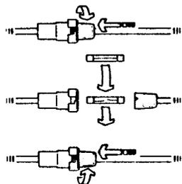
Se il fusibile salta, oppure l'apparato smette di funzionare, cercate prima di individuare la causa del problema, se possibile, e poi sostituite il fusibile bruciato con uno nuovo, di portata adeguata.
