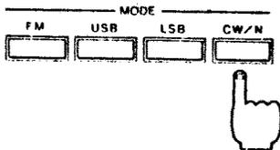
3) Premete il TASTO del MODO [CW/N] una volta o due volte, per selezionare in alternativa il Modo CW o il Modo CW-Narrow (a banda stretta).
