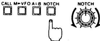
Questa funzione si puo' usare per ridurre o eliminare i segnali di battimento che interferiscono, qualora cadano entro la banda passante del ricevitore. Si veda il PARAGRAFO 7-9 per informazioni piu' dettagliate.
