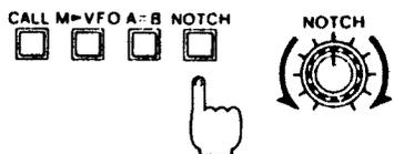
Questa funzione si può usare per ridurre o eliminare i segnali di battimento che interferiscono, qualora cadano entro la banda passante del ricevitore. Si veda il PARAGRAFO 7-9 per ulteriori informazioni.
