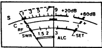
Nei Modi SSB e CW, l'apparato puo' ricevere i segnali che superano il livello che viene impostato sullo strumento.
