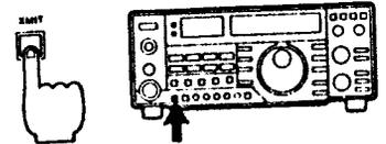
2) Selezionate il Modo di trasmissione tramite il TASTO [XMIT] oppure il DEVIATORE [BK-IN] sul pannello posteriore. Si veda piu' avanti la descrizione del FUNZIONAMENTO BREAK-IN.
