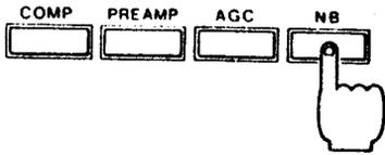
Questa e' una funzione molto utile, che riduce i disturbi di tipo impulsivo, come quelli prodotti dai sistemi di accensione delle automobili. Si veda il PARAGRAFO 7-4 per informazioni piu' dettagliate.
