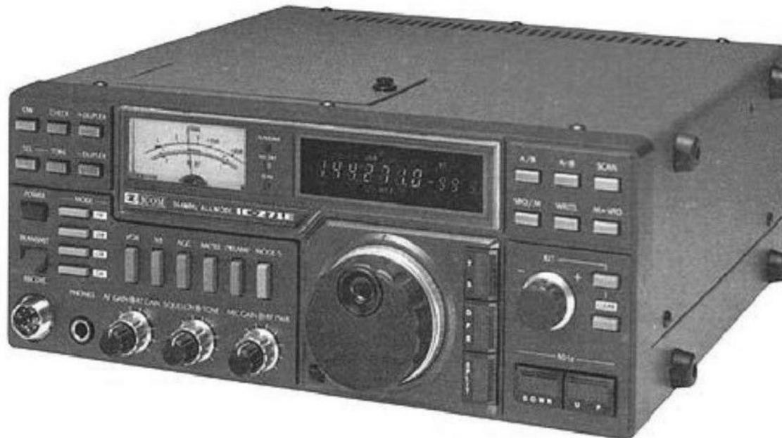
**L'apparato**, rispetto al modello precedente, comprende diverse innovazioni che permettono delle possibilità operative notevolmente maggiori. La determinazione della frequenza è data da un circuito PLL a basso rumore e di alta stabilità governato dal  $\mu P$ . La sezione ricevente incorpora uno stadio di RF ed uno stadio miscelatore in cui dei FET con ottime caratteristiche intrinseche prevengono la modulazione incrociata dovuta a torti segnali all'ingresso.
