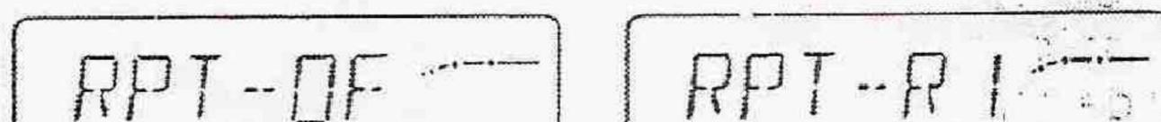
4. Gire o dial de sintonia para colocar a função do repetidor automático em "R1", "R2", ou OFF.
