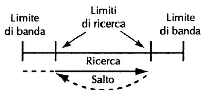
La ricerca si avvia entro dei limiti in frequenza. Utile per la ricerca entro una banda ristretta quale ad es. le frequenze d'uscita di un gruppo di ripetitori. Sono a disposizione cinque coppie di memorie per registrarvi i rispettivi limiti in frequenza.
