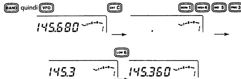
**ESEMPIO:** impostare la frequenza di 446.325 MHz (mentre vige l'incremento di 25 kHz)
