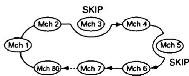
La ricerca si avvia fra le memorie salvo quelle predisposte per essere escluse con la funzione "SKIP". Usata per controllare delle frequenze trafficate escludendo però quelle sempre occupate (da portante o altro).
