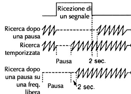
Sono a disposizione cinque condizioni per il riavvio: tre del tipo temporizzato (5, 10, 15 s) dopo una pausa, sinché il segnale viene a cessare per riprendere 2 s più tardi, oppure una sosta indefinita su una frequenza libera sinché un segnale verrà ricevuto e riprendere quindi dopo un intervallo di 2 s.
