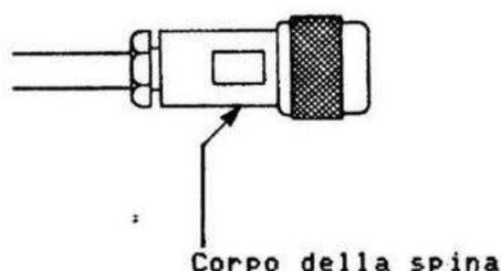
1. Infilate il dado, la rondella, la guarnizione ed il pressore sul cavo coassiale, e tagliate di netto l' estremita' del cavo.
