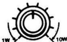
Questa manopola varia la potenza di uscita RF da 1 W fino alla massima. Ruotate la manopola in senso orario per aumentare la potenza di uscita.
