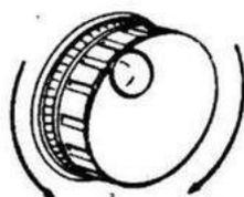
Ruotate questa manopola in senso orario per aumentare la frequenza od il numero del Canale di memoria, ed in senso antiorario per diminuire i suddetti. La frequenza varia a passi di 100 Hz nei Modi operativi USB, LSB e CW, ed a passi di 25 kHz nel Modo operativo FM.
