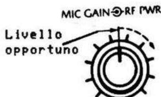
Regolate questa manopola per un conveniente livello di modulazione, mentre parlate davanti al microfono con voce normale. Ruotate la manopola in senso orario per aumentare il guadagno.
