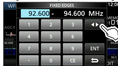
6. Drücken Sie die Zifferntasten oder drehen Sie **DIAL C**, um die Frequenz zu ändern, berühren Sie dann [ENT].
