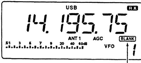
Il visore indica "BLANK" sopra il numero della memoria al fine di evidenziare l'assenza dei dati. Per registrare mantenere premuto per 2 s il tasto [MW].
