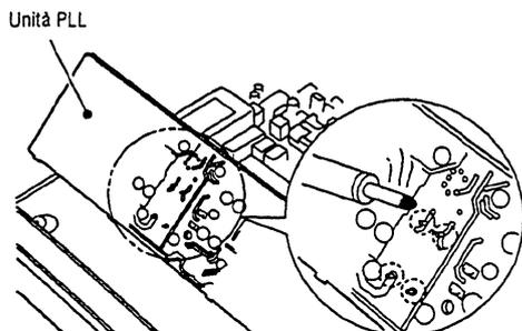
3. Togliere il cristallo interno esistente e sostituirlo con l'unità CR-282.
