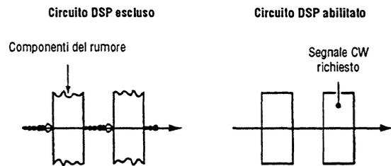
**NOTA:** non eccedere con il livello d'intervento in quanto si avrebbe distorsione. Regolare il livello [NR] per la migliore comprensibilità. Il circuito non è funzionante in AM ed in FM.
