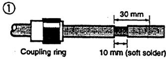
Fare scorrere l'anello di fissaggio lungo il cavo. Spellare la guaina della misura illustrata e stagnare la calza.
