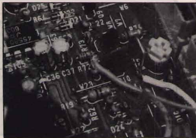
③ Il collegamento del filo di ingresso con R_{72} e del filo di uscita con il diodo D_a .
