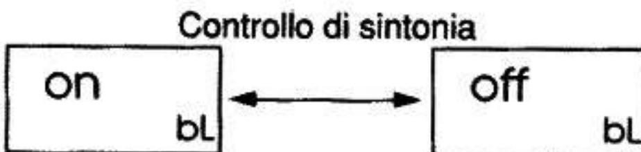
Include o esclude il Led di ricezione. Nella posizione di "ON" il Led si accende quando un segnale viene ricevuto; l'opposto nella posizione di "OFF".
