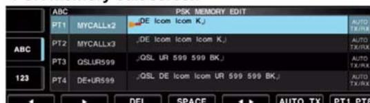
2. Mediante il tasto [F-4•TX MEM] selezionare il PSK memory screen dopodiché azionare [F-6•EDIT] in modo da ottenere il PSK memory edit screen.
