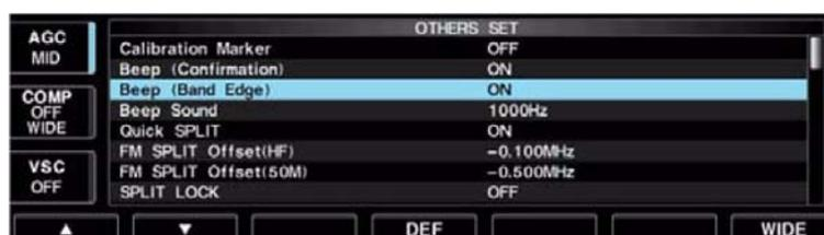
Si udrà un tono di avviso quando la sintonia avviene oltre il limite della banda radiantistica. Se richiesto la funzione può essere esclusa tramite il modo SET.
