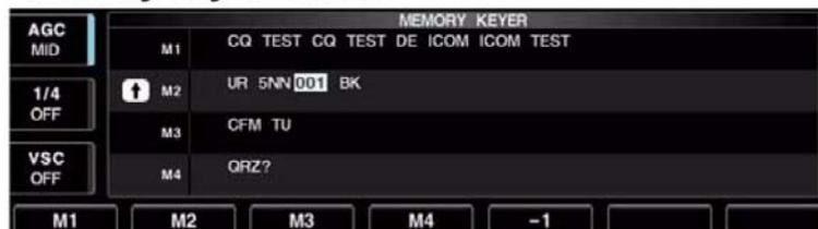
Mediante il 'keyer send menu' è possibile trasmettere dei caratteri già pre-impostati. I messaggi potranno venire predisposti tramite il menu 'edit'.
