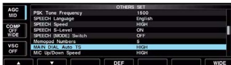
In questo caso la velocità con cui procede la sintonia dipende dalla velocità di rotazione del controllo di sintonia ovvero, maggiore quest'ultima più vistosi saranno gli incrementi di sintonia ottenuti.
