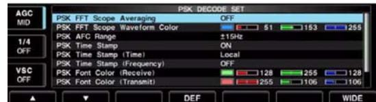
1. Premere [F-3•DECODE] al fine da ottenere il 'decoder screen' (presentazione per il demodulatore).
