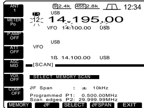
8. Quand le balayage détecte un signal, le balayage s'arrête, marque un temps d'arrêt ou ignore tout cela, tout dépend de la programmation des fonctions de reprise est des conditions de squelch.
