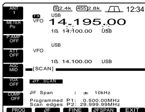
9. Quand le balayage détecte un signal, le balayage s'arrête, marque un temps d'arrêt ou ignore tout cela, tout dépend de la programmation des fonctions de reprise et des conditions de squelch.
