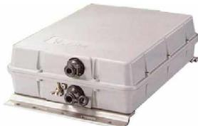
Pour l'utilisation en portable ou en mobile. Le démarrage de la fonction d'accord avec le PTT permet une utilisation très facile. Puissance d'entrée maximum : 150 W
