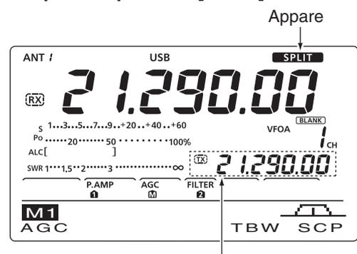
Indica la frequenza equalizzata di trasmissione (VFO B)
