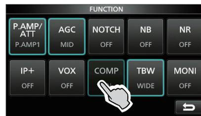
11. Ao falar no microfone com tom de voz normal, ajustar o nível do Compressor de Voz para a leitura do medidor COMP dentro da zona COMP (faixa de 10 a 20 dB).
