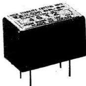
Quarzo compensato in temperatura che consente un'elevata stabilità di frequenza
