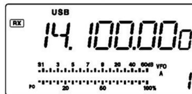
La rotazione del controllo di sintonia apporta delle variazioni di 1 Hz
