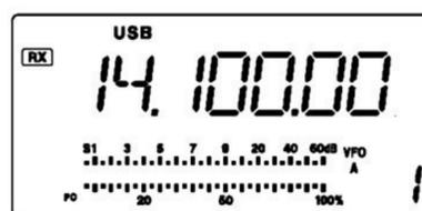
La rotazione del controllo di sintonia apporta delle variazioni di 10 Hz
