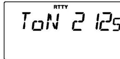
Il valore "Mark" è impostato su 2125 Hz. Sono pure a disposizione i valori di 1615 e 1275 Hz
