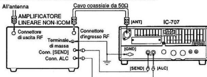
**NOTA:** Con il connettore [SEND] si potrà controllare un amplificatore lineare con le queste caratteristiche:
