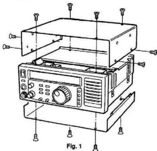
**Smontaggio del coperchio sopra l'unità di potenza (PA)**
