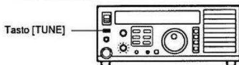
Il modo CW viene selezionato automaticamente e l'indicazione "TUNE" è intermittente
