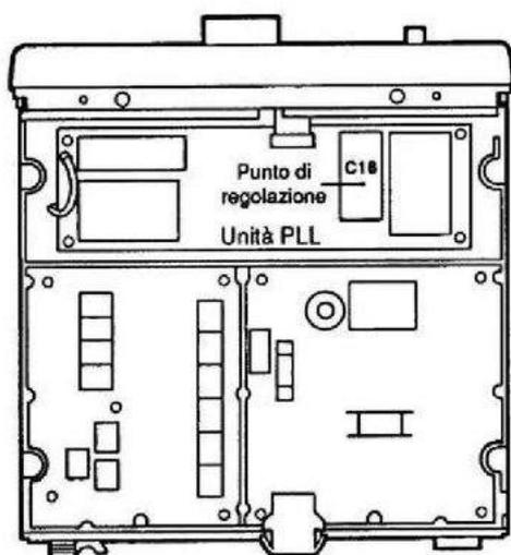
Collegarvi il contatore come illustrato e regolare accuratamente la frequenza.
