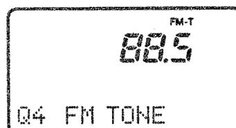
Impostare la frequenza del tono sub-audio (tramite l'impostazione rapida). Più avanti nel manuale sono indicate le frequenze a disposizione.
