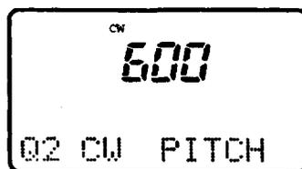
Viene indicato il valore impostato all'origine: 600 Hz per la nota di controllo.
