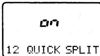
Abilitare la funzione dello Split Rapido. (tramite il modo SET Iniziale originariamente posto su ON).
