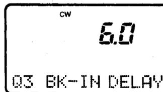
Per il semi break-in è stato predisposto un ritardo equivalente a 6 punti tramite il modo SET Rapido.
