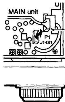
Togliere dall'unità PLL il connettore J1431 e sostituirlo con il connettore del UT-106.
