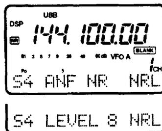
**NOTA:** L'azionamento su [(F-3)NR] inserisce - ON - il DSP in modo automatico. Comunque il ricevitore mantiene la condizione ON/OFF quando si aziona il tasto [(F-2)NR].
