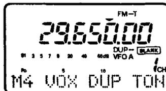
**NOTA:** nel caso fosse richiesto trasmettere il tono da 1750 Hz mediante azionamento sul [PTT] basterà azionare [(F-3)TON] con la presentazione M4 e con l'apparato predisposto per l'accesso ai ripetitori.
