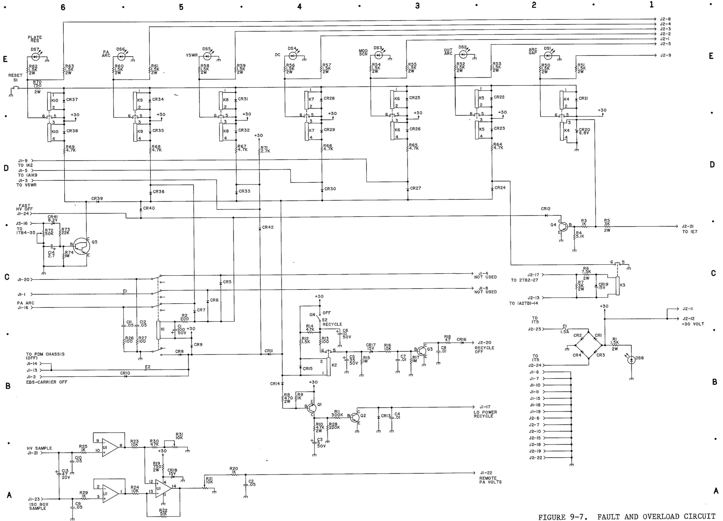
FIGURE 9-7. FAULT AND OVERLOAD CIRCUIT
