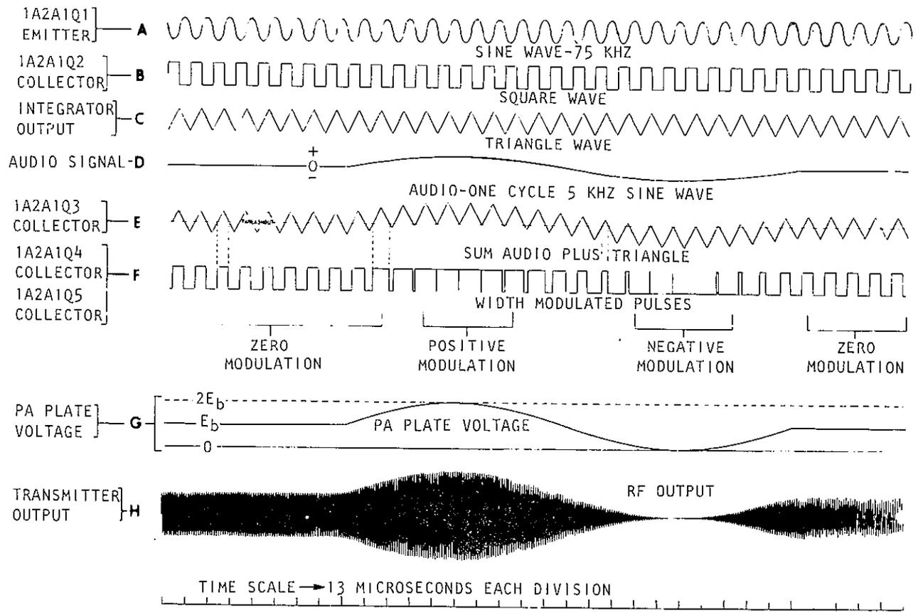
Figure 4-9. PDM Waveform
