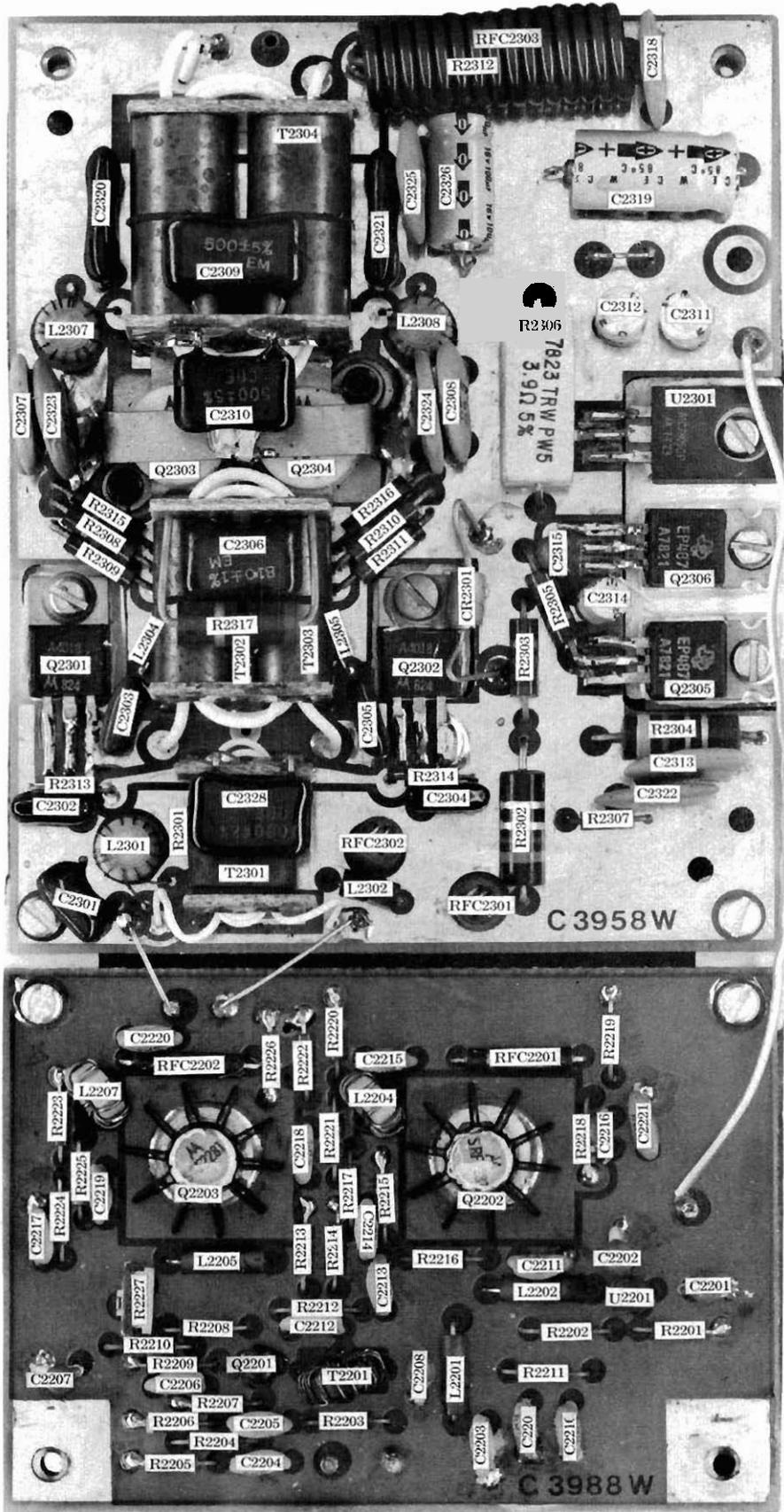
Fig. 2-39 Power Amplifier Module Pictorial (w/Predriver Bd. #1)
