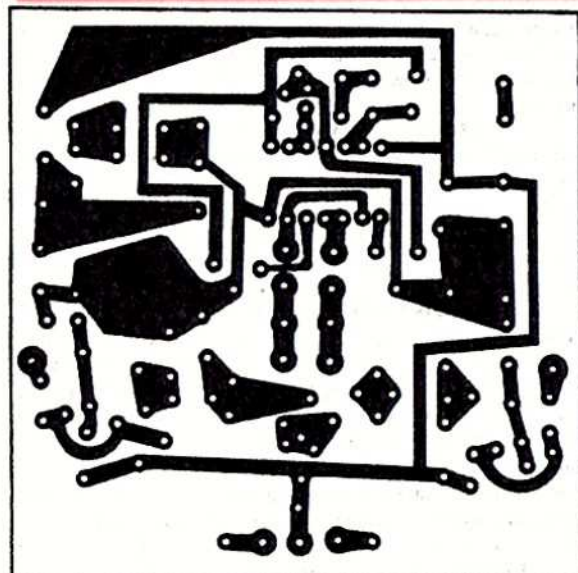
Rys. 2. Płytkę drukowaną przystawki – widok od strony druku (skala 1:1)
