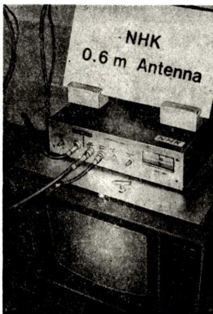
Rys. 4. Konwerter z pasma 12 GHz na pasmo 400–700 MHz (Fot. Funkschau nr 7/77).
