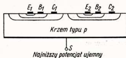
Rys. 2. Struktura zawierająca dwa niezależne tranzystory
