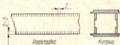
Rys. 17. Sposób przygotowania przekładek papierowych międzyzwojowych
