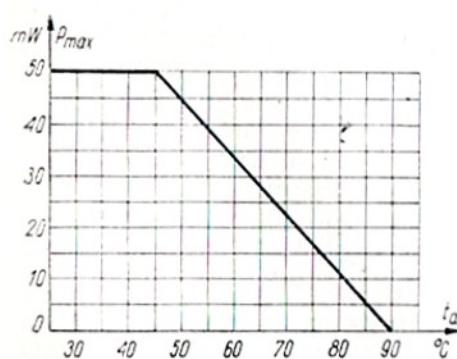
Rys. 2. Zależność mocy maksymalnej od temperatury otoczenia
