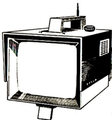
Rys. 11. Turystyczny odbornik telewizyjny tranzystorowy firmy Tesla
