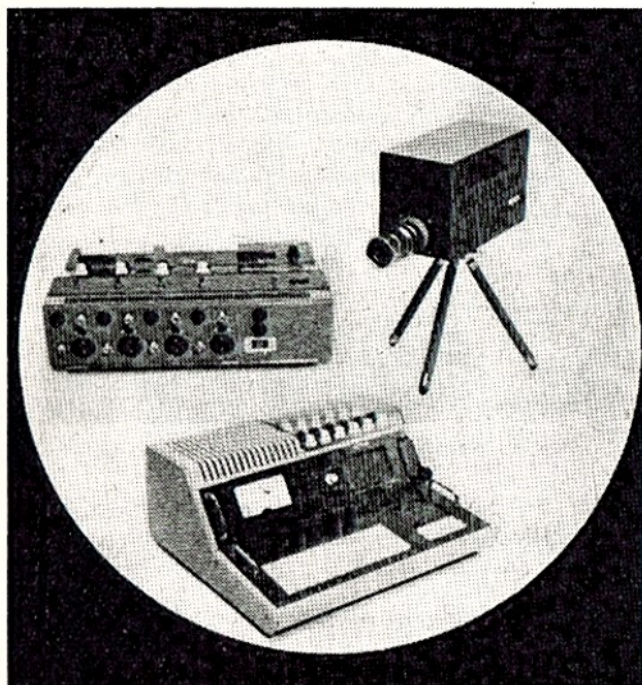
Rys. 6. Wygląd kamery i pulpitu sterowniczego jednego z zestawów telewizji przemysłowej
