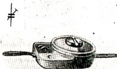
Rys. 6. Kondensator obrotowy 2 \times 460 \mu\text{F} i jego symbol graficzny
