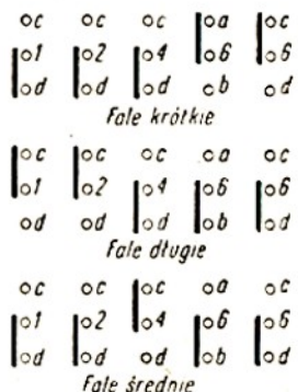
Rys. 1. Schemat połączeń obwodów wejściowych strojonych kondensatorem
